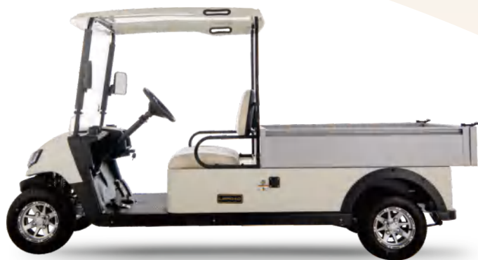
·L2 铝货箱 铝货箱尺寸：1478*1145*270mm
